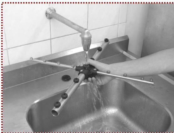
12° Montar os tampões nas extremidades dos braços de lavagem, encaixar os braços giratórios nos seus respectivos eixos, montar os parafusos sede e os tampões. Girar manualmente os braços nos dois sentidos e verificar se giram livremente; caso não girem livremente, retirar o braço giratório, limpar o eixo e o interior da bucha central do corpo, com água corrente ou pano umedecido.
