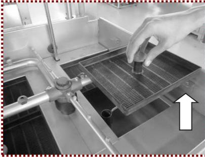
5° Posicionar o braço de lavagem inferior alinhado com o tanque, e remover os cestos de resíduos, procurando não inclina-los além do ponto em que os resíduos caíam para dentro do tanque da lavadora.
