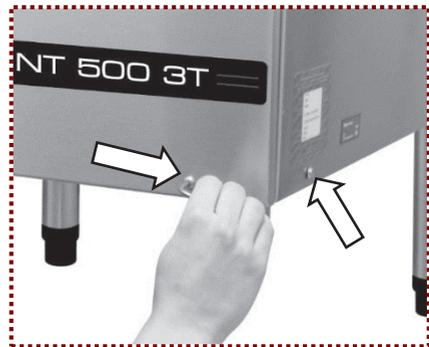
4° Rosqueie os parafusos de fixação do painel frontal; do painel lateral direito e do painel traseiro, utilizando uma Allen 4 mm (APERTAR SUAVEMENTE).
