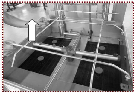
3° Posicionar o braço de lavagem inferior alinhado com o tanque, e remover os cestos de resíduos.
