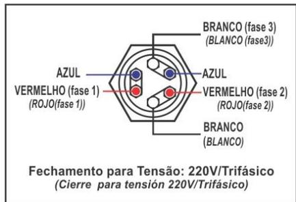
6° Realizar ligação do motor da bomba de lavagem, para fechamento 220 V 3~.
