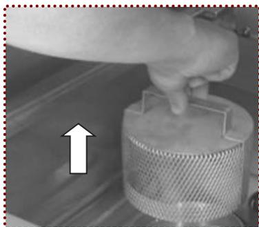
8° Aguarde a drenagem da solução do tanque, e retire o filtro da moto-bomba de lavagem.
