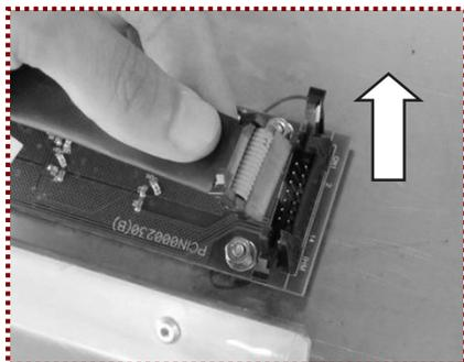
3° Na parte interna do painel frontal, desconecte o terminal do chicote da placa, puxando o conector para cima.
